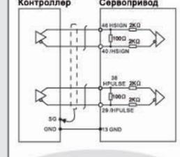
Предупреждение! Убедитесь, что клеммы GND контроллера и сервопривода соединены друг с другом.
