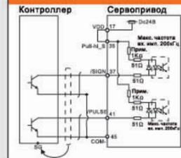
Импульсный вход при использовании внешнего источника питания (open collector)
