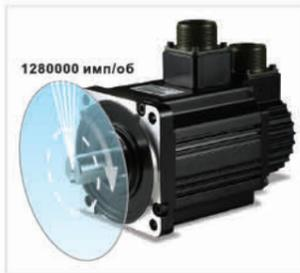
Поддержка абсолютных энкодеров. Исходная позиция будет сохранена при выключении питания привода. Внешняя батарея для абсолютного энкодера легко устанавливается и подключается в специальном отсеке.
