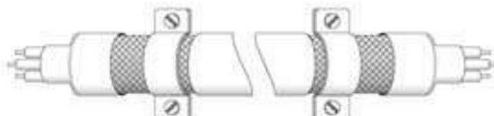
Заземление экрана на обоих концах кабеля
