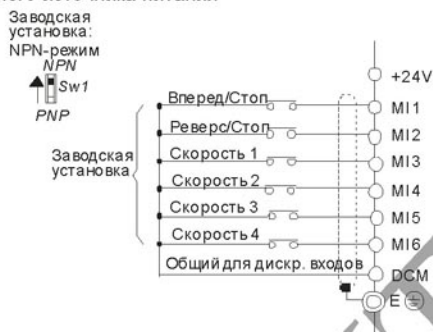
Рисунок 7. Выбор логики управления дискретными входами микропереключателем Sw1.
